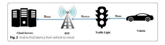
$$TD_{DL}^{TL2RSU}(t) = (PDCCH_{dur} + t_D + PDSCH_{dur} + t_{DUS} + ULACK_{dur} * \left[ \frac{DataLen}{TBS(MCS; RBU)} \right]$$
